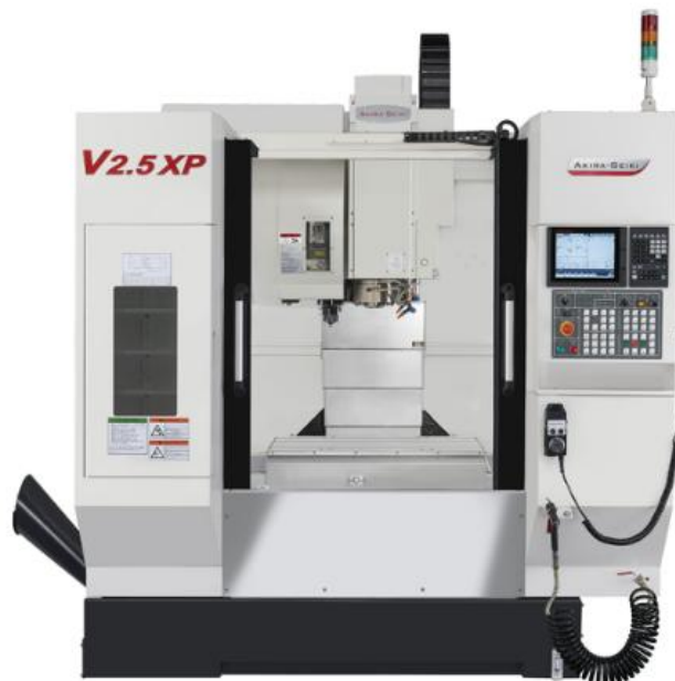
19. ábra Akira-Seiki V2.5XP vertikális megmunkáló központ
