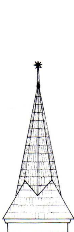
zsindelyfedés 388 1813-41. bádofedés 389 1841-72. keresztmetszet az 1945-ben készült provizórikus sisakkal 390 (M = 1:100) (M = 1:100) (M = 1:100)
