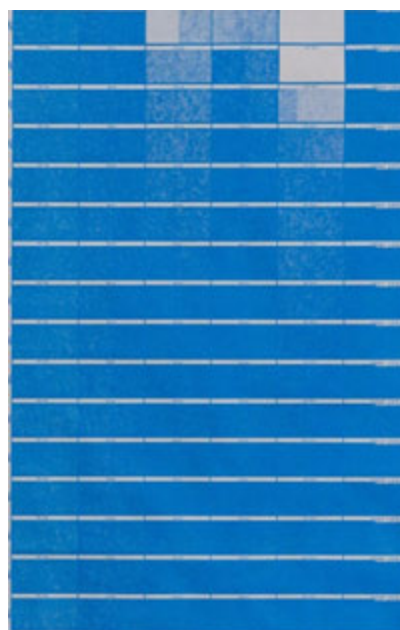
44.ábra: A DuPont™ Cyrel® DPN nyomtatási eredményei barna kraft papíron és a scannelt nyomatminta (jobbra)
