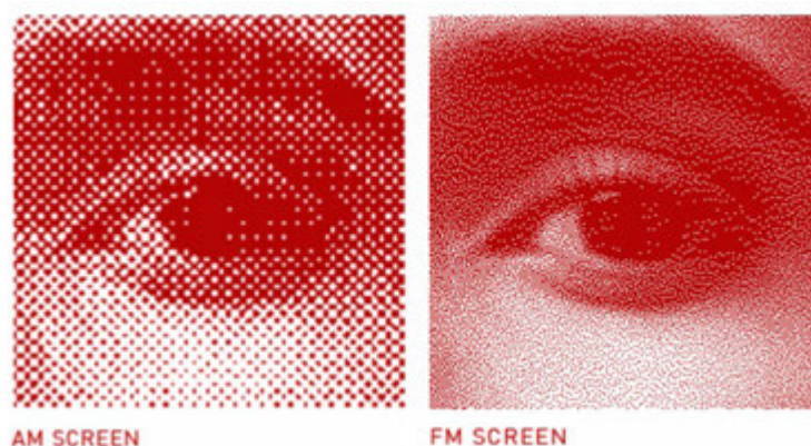
16.ábra: AM és FM rácsozat összehasonlítása (Forrás: Papermore)
