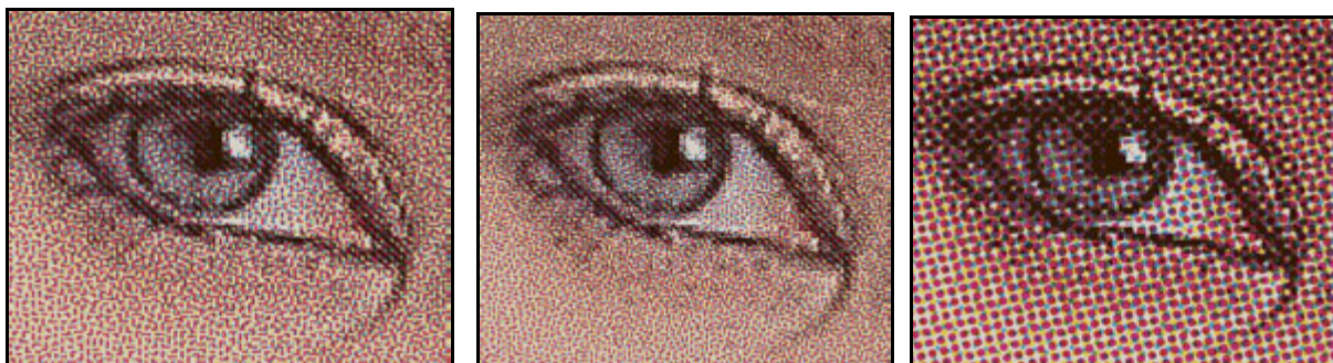
53.ábra: Magas felbontású fotó a Bellissima rácsszerkezetére összehasonlítva egy 150 lpi AM felbontású nyomattal (Standard Screen balra, eXtended screen középen, 150 lpi AM rács jobbra) (Forrás: Hamillroad Ltd.)
