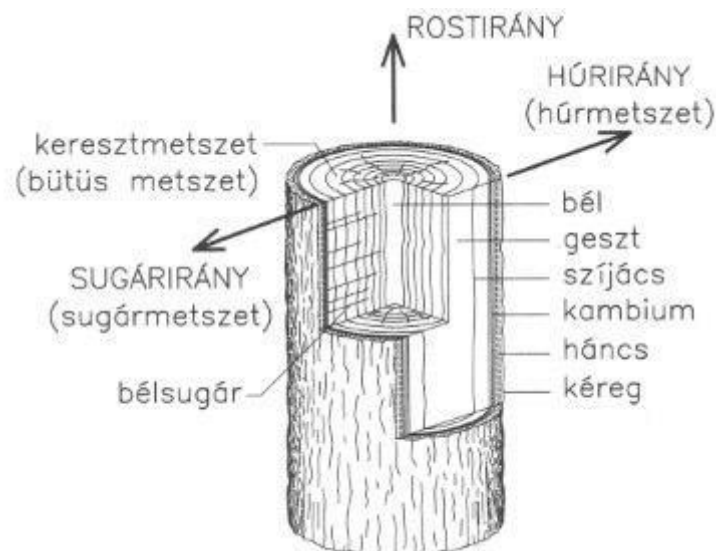
2. ábra: A fa szerkezeti felépítése (Varga 2012)
