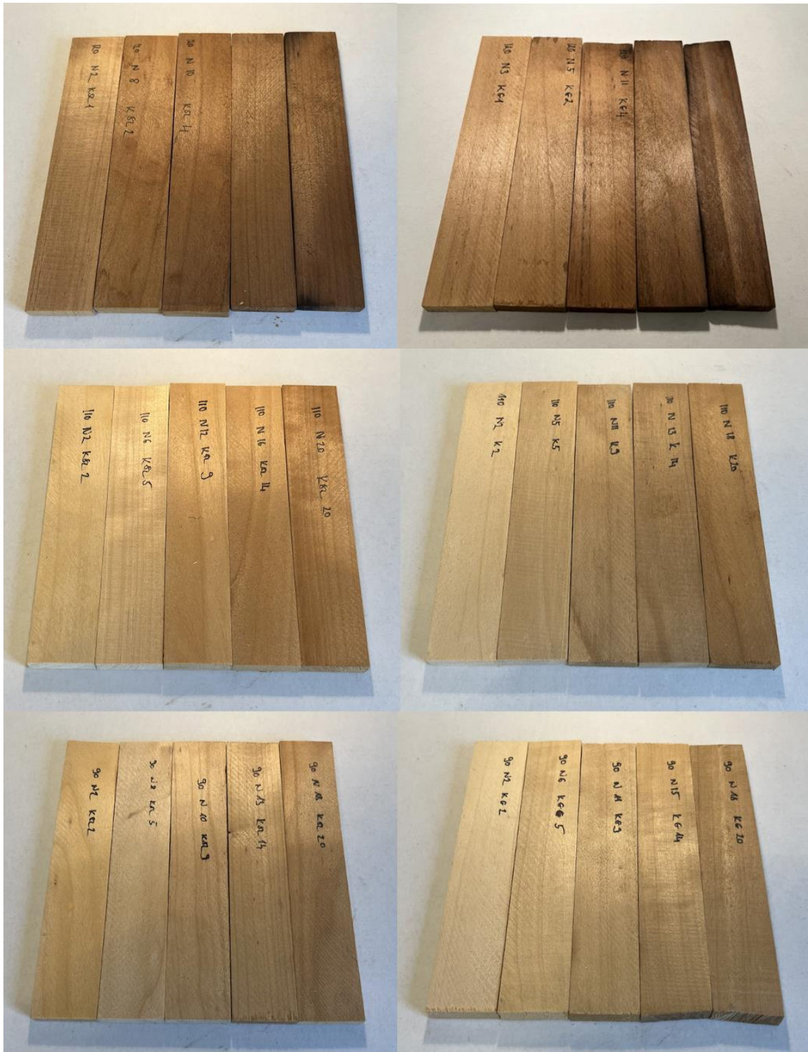
26. ábra: Gőzölt nyár minták színváltozásai. Bal oldalon a geszt, jobb oldalon a szijács változásai. Lentről felfelé nő a gőzölési hőmérséklet (90°C; 110°C; 120°C), balról jobbra pedig a gőzölési idő (2;5;9;14;20 nap. 120°C esetében: 1;2;4;6;9 nap)
