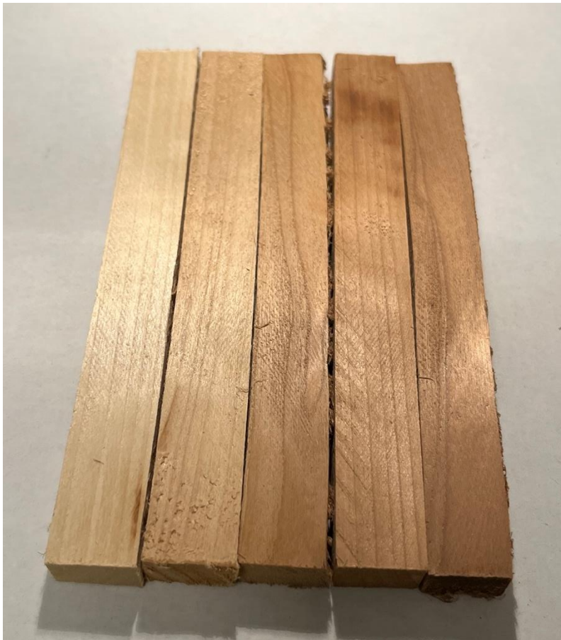
15. ábra: 100°C-on, 2;5;9;14 és 20 napig gőzölt nyár minták
