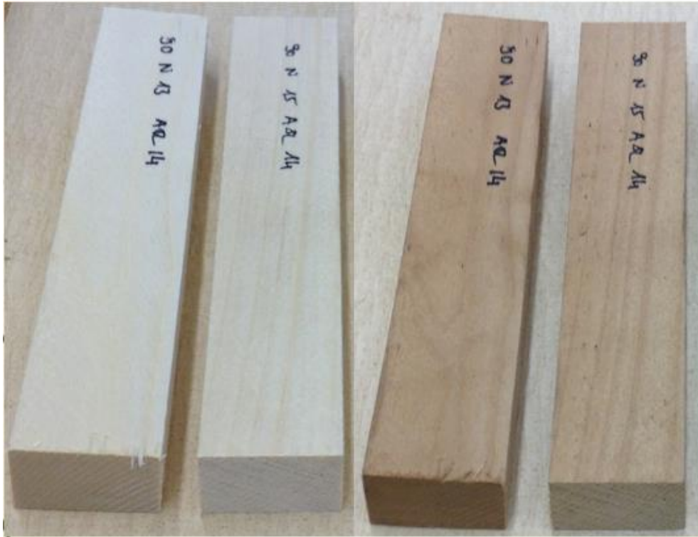
27. ábra: Bal oldalon kezeletlen minták, jobb oldalon ugyanazok a minták láthatók 90°C-os és 14 napos kezelés után
