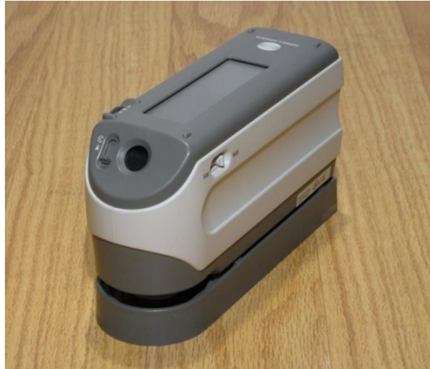
10. ábra: KONICA-MINOLTA 2600d színmérő készülék
