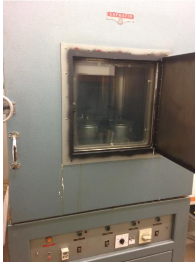
13. ábra: A nyomástartó edények 90, 100 és 110 °C -on a szárítószekrényben, 120°C -on nyomástartó hengerben voltak.
