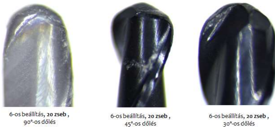
5.30. ábra: 6-os technológiai beállítás: Axiális fogásmélység: 0,3mm, Radiális fogásmélység:0,05mm, Fordulatszám : 25000 [1/min], Előtolási sebesség : 300 [mm/min]
