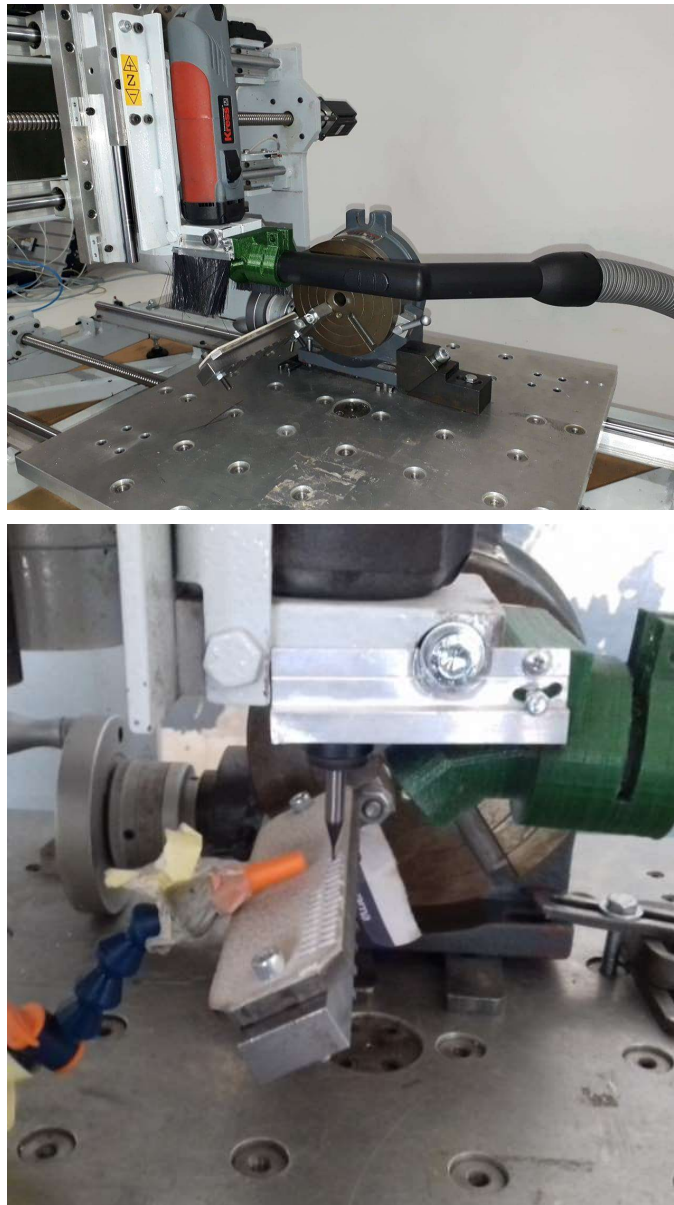
5.19. ábra: Munkadarab bedöntésre alkalmas készülék modell, és ebben a környezetben futtatandó szerszám pálya
