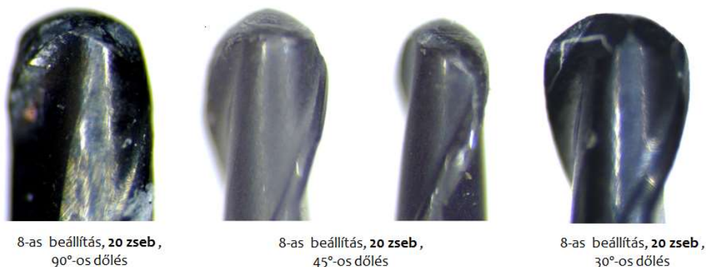
5.31. ábra: 8-as technológiai beállítás: Axiális fogásmélység: 0.3mm, Radiális fogásmélység: 0.3mm, Fordulatszám: 25000 [1/min], Előtolási sebesség: 300 [mm/min]
