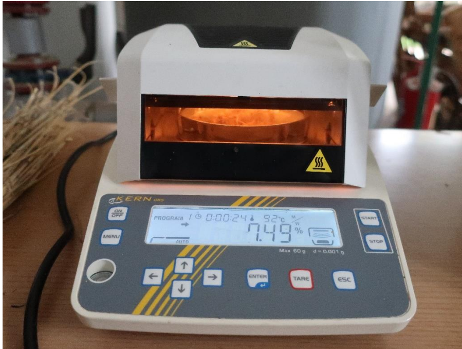
13. ábra: Kern DBS típusú nedvesség analízátor (saját fotó)
