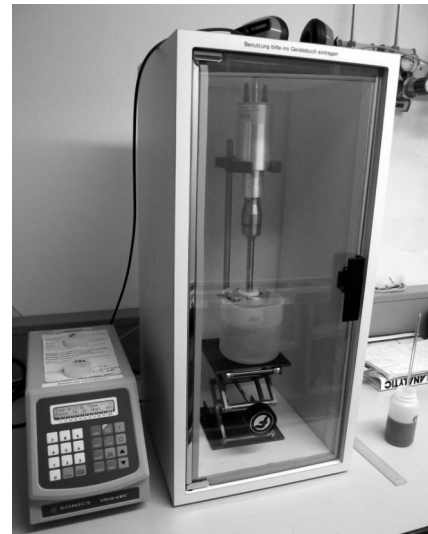
6. ábra. Sonics & Materials – Vibra-Cell VCX-750 ultrahang-egység a minták dezaggregához (saját felvétel).
