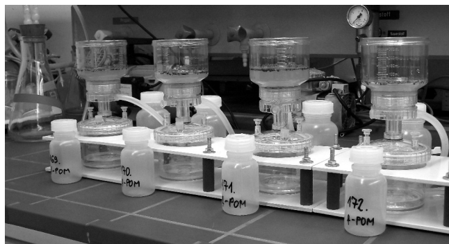
7. ábra. Mintamosás vákuum-szűrőállványok segítségével (saját felvétel).
