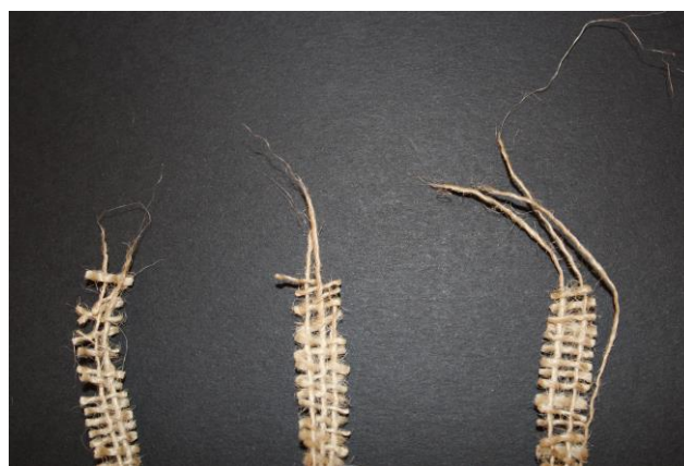
72. kép: jutaszövet próbatetek szakadásképe
