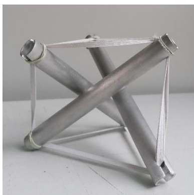
54. kép: elemi tensegrity cella modellje
