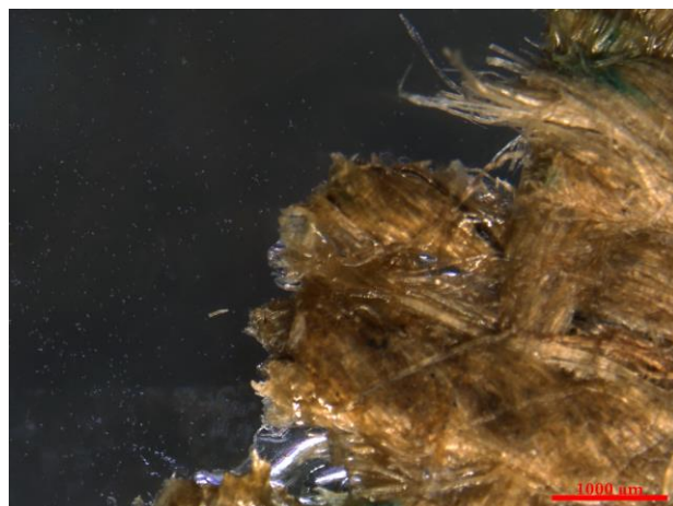
76. kép: A próbatest roncsolt felészíne sztereomikroszkóp alatt
