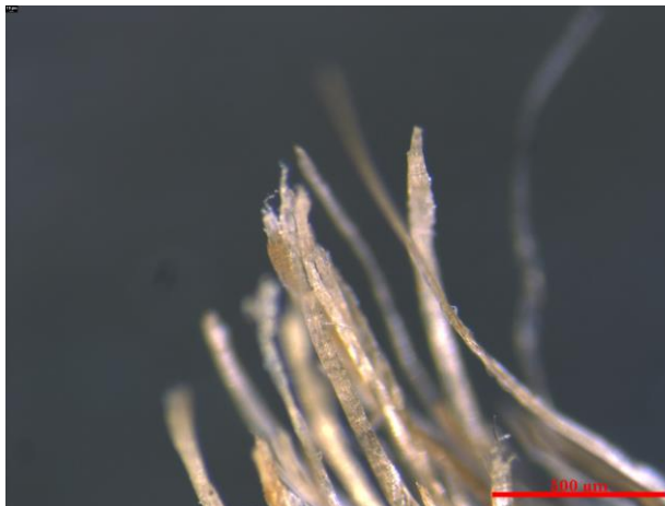
80. kép: kihúzódt szálak sztereomikroszkópos képe
