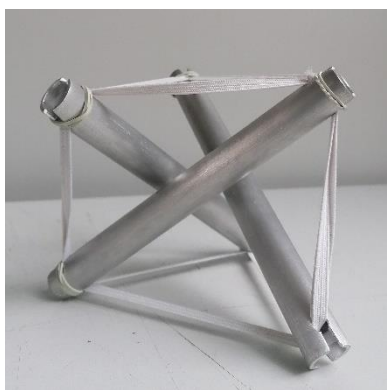
54. kép: elemi tensegrity cella modellje
