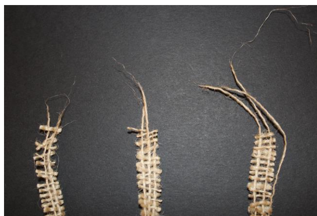
72. kép: jutaszövet próbatetek szakadásképe
