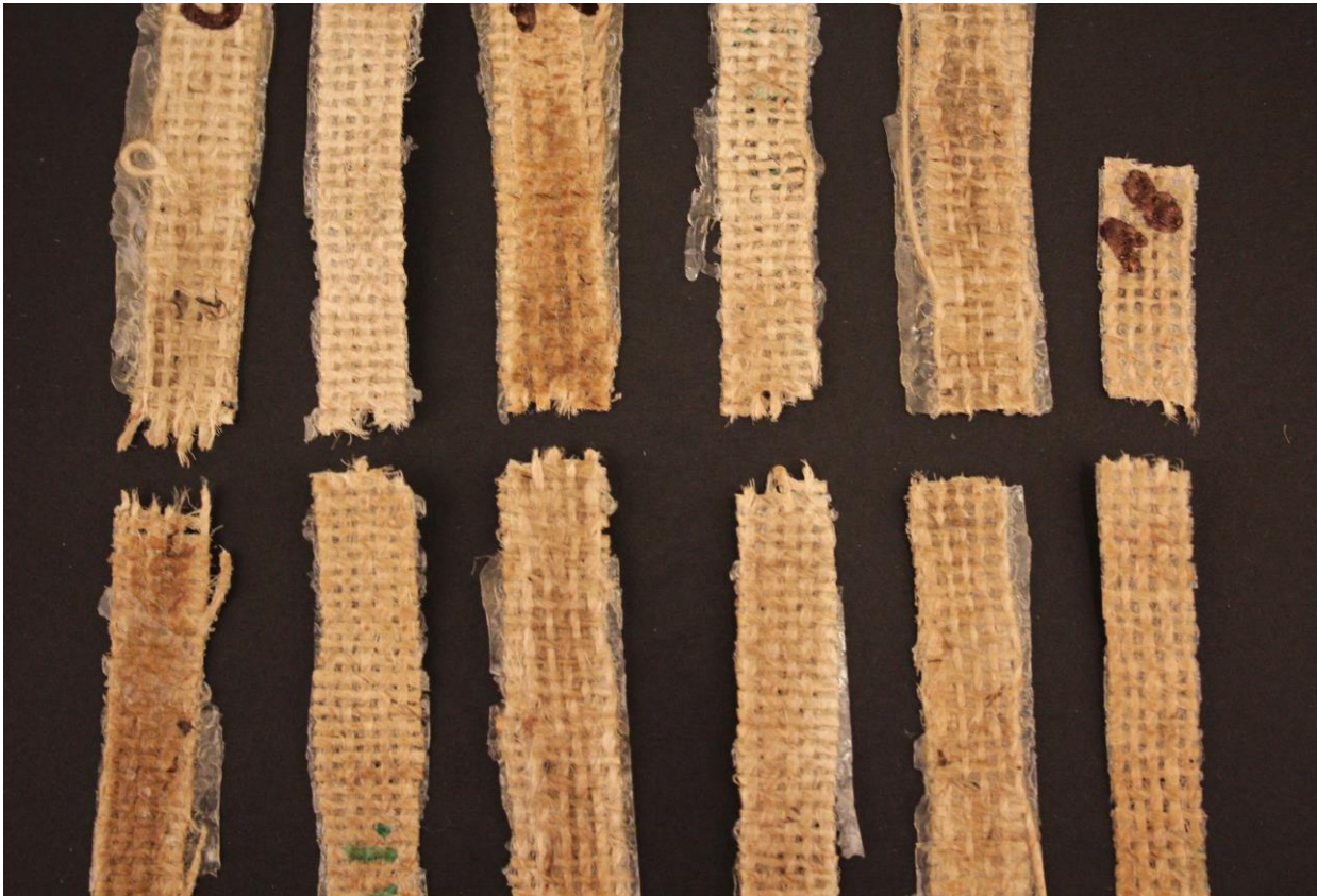
68. kép: A1, A2 és A3 próbatetek szakadási képe
