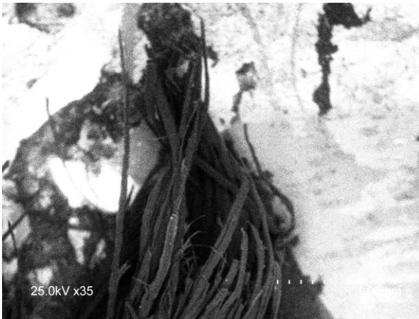
81. kép: Szálkihúzóds SEM felvételen
