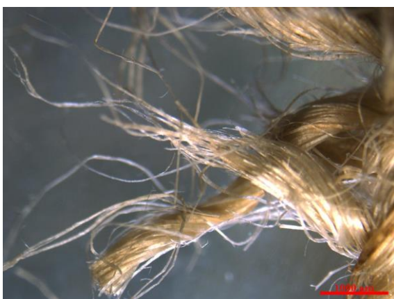
71. kép: kezelés nélküli jutaszövet ellenőrző minta szakítás után. Sztereoó mikroszkópos felvétel.
