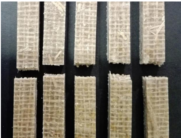
69. kép: C1 próbatetek szakadási képe
