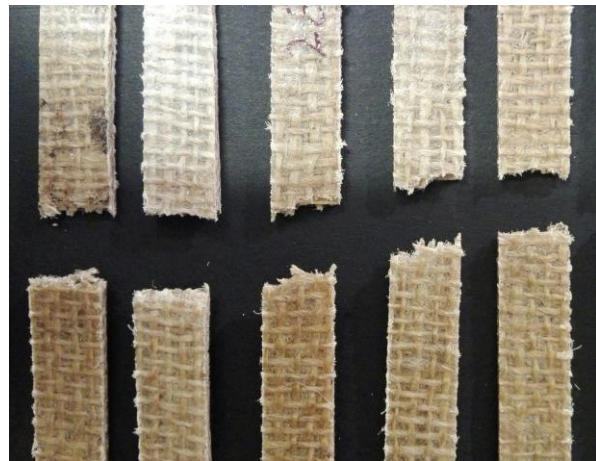
70. kép: C2 próbatetek szakadási képe
