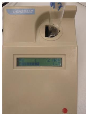
14. ábra: A baktériumsűrűség beállításához használt eszköz, használat közben
