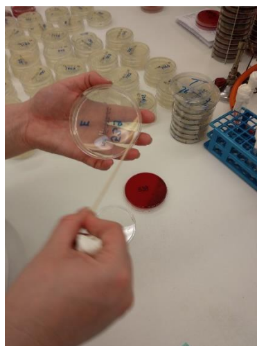
18. ábra: A baktérium, gomba inokulum szélesztése
