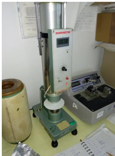
13. ábra: L&amp;W Gurley denzitométer használat közben
