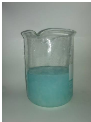
8. ábra: Réz-szulfát hozzáadásával készült, 4,5 pH értékű cellulóz rost szuszpenzió
