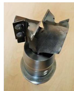
38. ábra MAKA SC 20T típusú CNC vezérlésű felsőmaró és a maráshoz használt szerszám (Saját felvétel)
