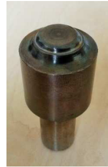
40. ábra A termikus simítás műveletéhez használt szerszám (Saját felvétel)
