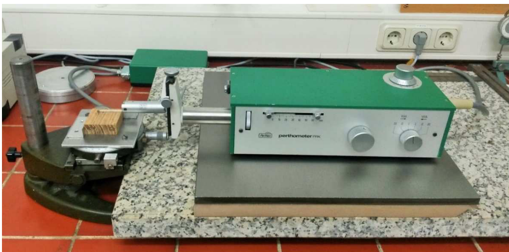
87. ábra Tapintótűs érdességmérő berendezés (Perthometer PRK)(Saját felvétel)
