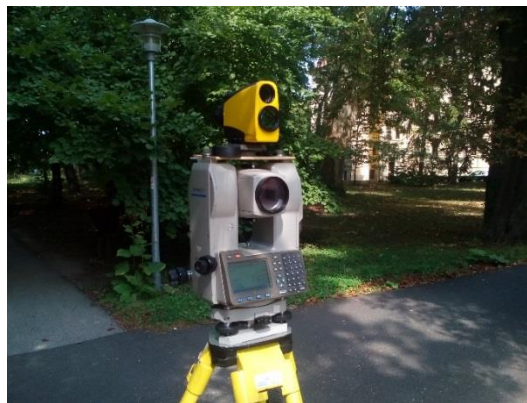
35. ábra: A határszög megállapításához alkalmazott műszerrögzítés.
