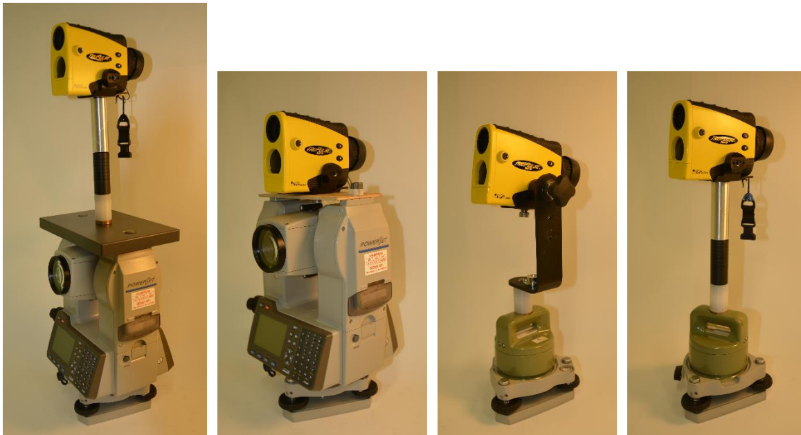
16. ábra: A TruPulse 360B esetén alkalmazott néhány központosítási megoldás.
