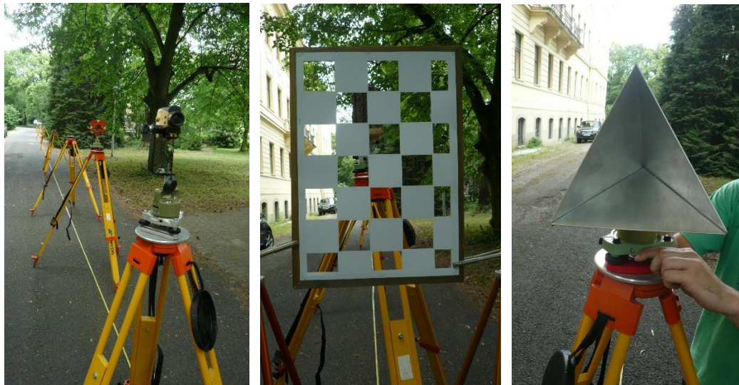
28. ábra: A távmérés vizsgálata különböző viszonyok között.
