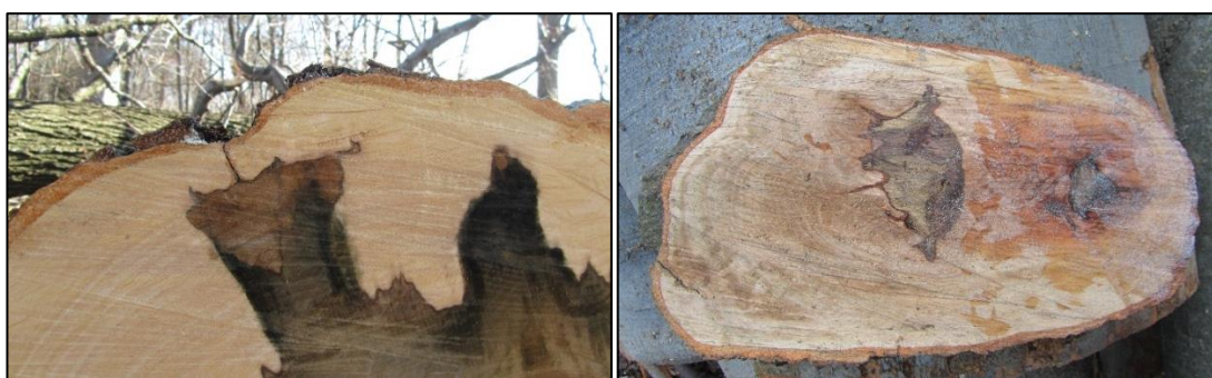
45. ábra: Kéregbenövések, kéregsérülések a kialakult álgeszttel
