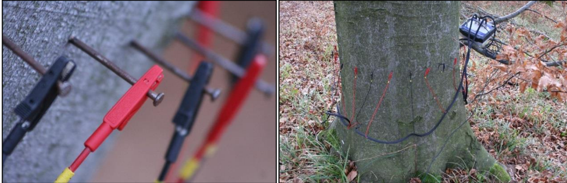
17. ábra: Picus TreeTronic műszer elektródái, és mérés közbeni állapota
