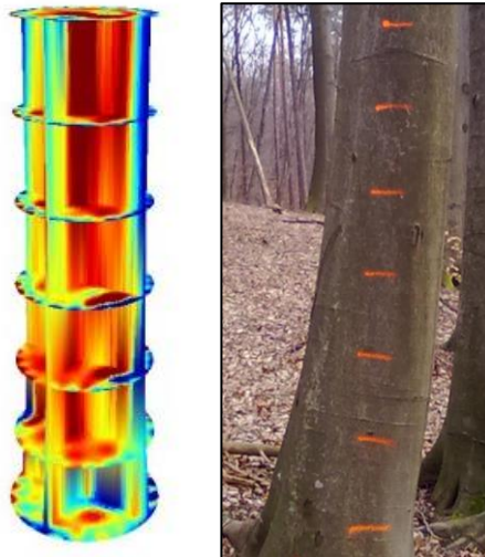
42. ábra: a 131/A/1 jelű bükkegyed 3D-s impedanciaterképe és fényképfelvétele
