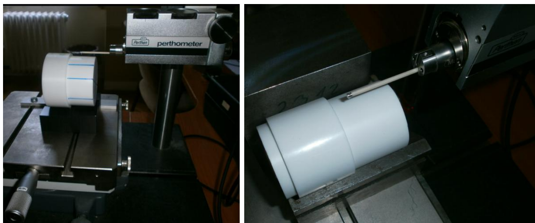
III.7. ábra. A felületi érdesség mérése
