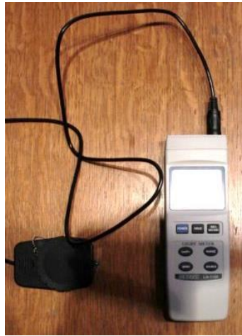
4.4. ábra: LX – 1108 digitális lux mérő (szerző felvétele)
