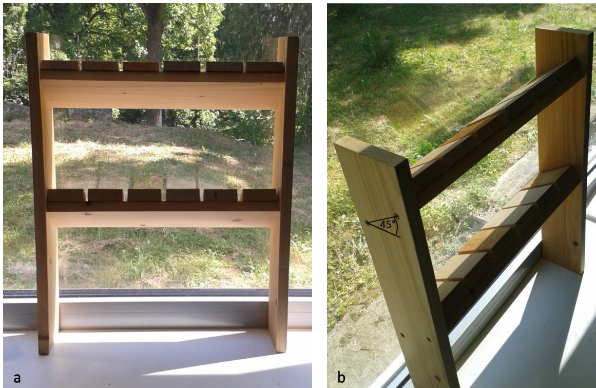
7. ábra Állvány mintatestek elhelyezéséhez természetes öregítés során (a: mintatartó állvány; b: mintatartó polc beállítása)
