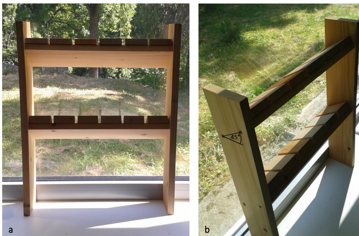
7. ábra Állvány mintatestek elhelyezéséhez természetes öregítés során (a: mintatartó állvány; b: mintatartó polc beállítása)
