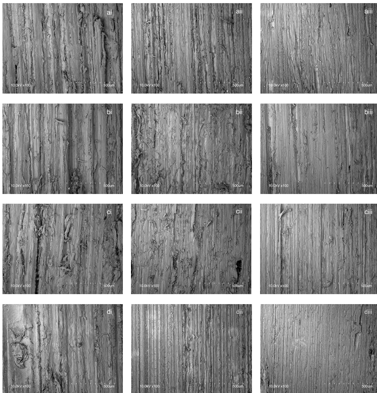
11. ábra Pásztázó elektronmikroszkópos felvételek a meghatározott érdesség tartományokhoz tartozó jellemző csiszolószemcse finomságú csiszolópapírral csiszolt felületeken
