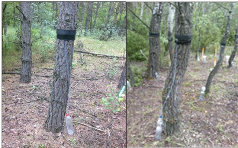
11. kép: A törzsi lefolyás mérése az erdeifenyves és a szürke nyáras faállományokban.
