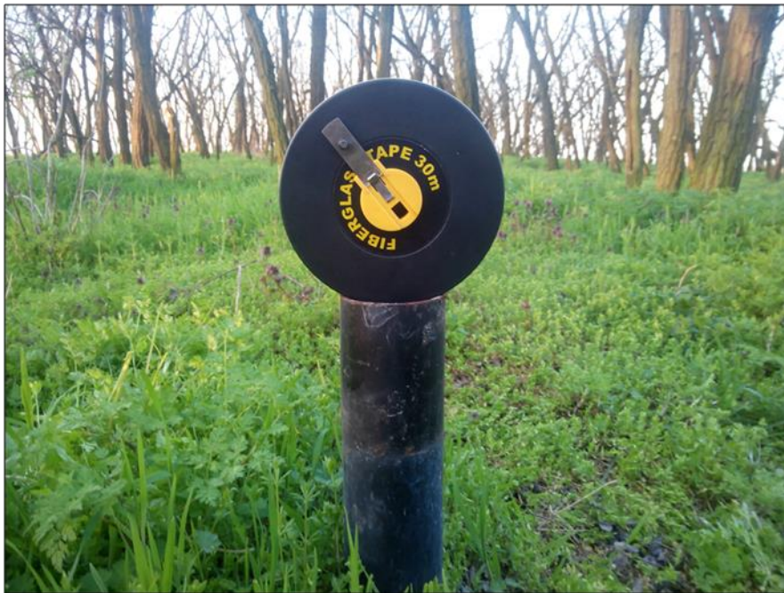
14. kép: Talajvízszint mérése DA-OP kézi vízszintmérővel (Pusztaszer 6 A erdőrészetben).
