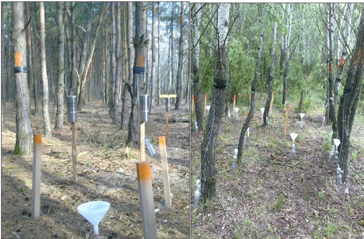
10. kép: A koronaintercepció mérése az erdeifenyves és a szürke nyáras faállományokban.
