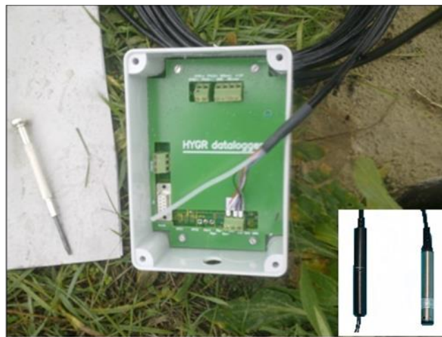
15. kép: Nyomásérzékelő egység bekötése a HYGR datalogger adatgyűjtőbe.
