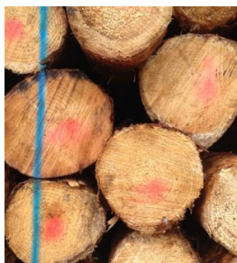
Abbildung 11: Markierungslinie für die Zuteilung der Versuchsstämme in die jeweilige Sektion
