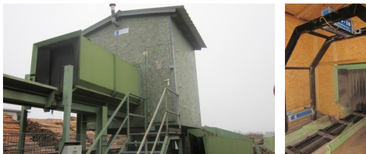
Abbildung 8: Vermessungsstation mit Laser-Kameraeinheiten des Typs JORO-3D
