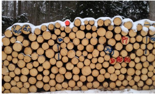
Abbildung 1: Industrieholz der Güteklasse IN in Holzart Fichte
