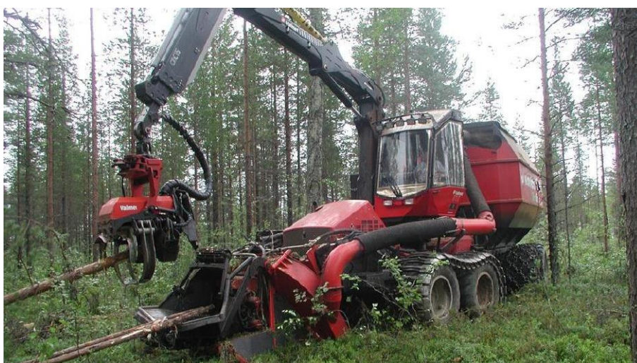
24. melléklet: Valmet 801 Combi BioEnergy döntő–gallyazó–daraboló–rakásoló–aprító gép (aprító-harveszter) (Forrás: www.komatsuforest.fi .)
