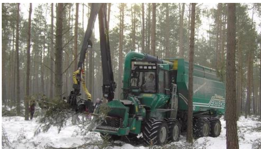
Silvatec 878 CH döntőfejjel (Forrás: www.silvatec.com )
