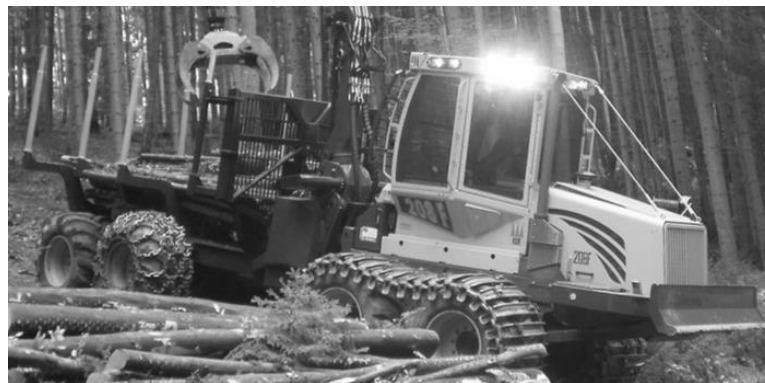
6. ábra: Láncsal és hevederrel felszerelt HSM 208F kihordó (Forrás: Saját fotó)
