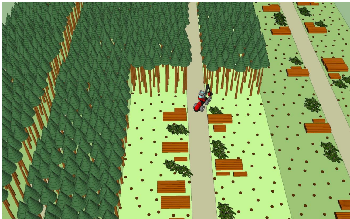
216. melléklet: Fenyves állomány tarvágása, párhuzamos közelítőnyomokról (SketchUp 3D modell) (Forrás: Saját ábra)
