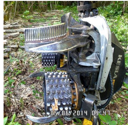
31. ábra: Bordás ívkések terepi vizsgálata (Forrás: Dargnat et al., 2014)
