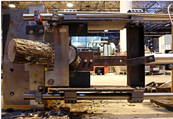
30. ábra: Bordás kés laboratóriumi vizsgálata (Forrás: Dargnat et al., 2014)
