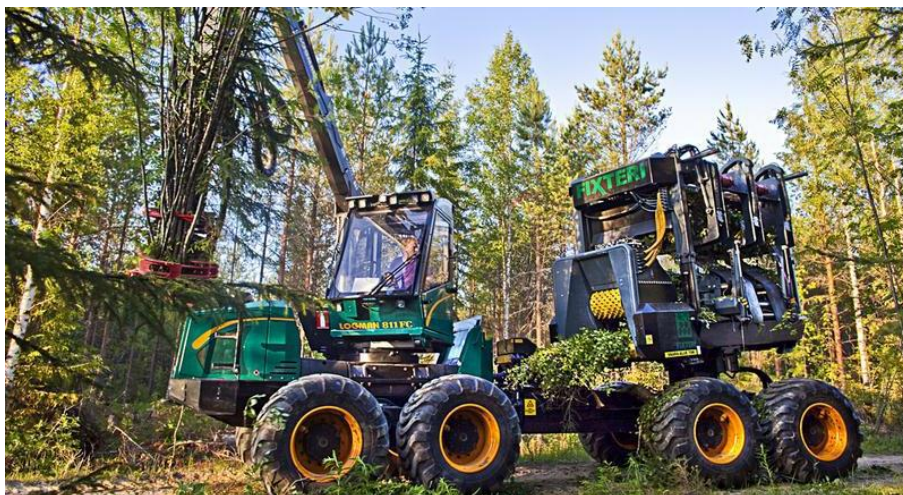
22. melléklet: Logmann – Fixteri döntő–kötegelő gép (Forrás: Lappalainen, 2011)
