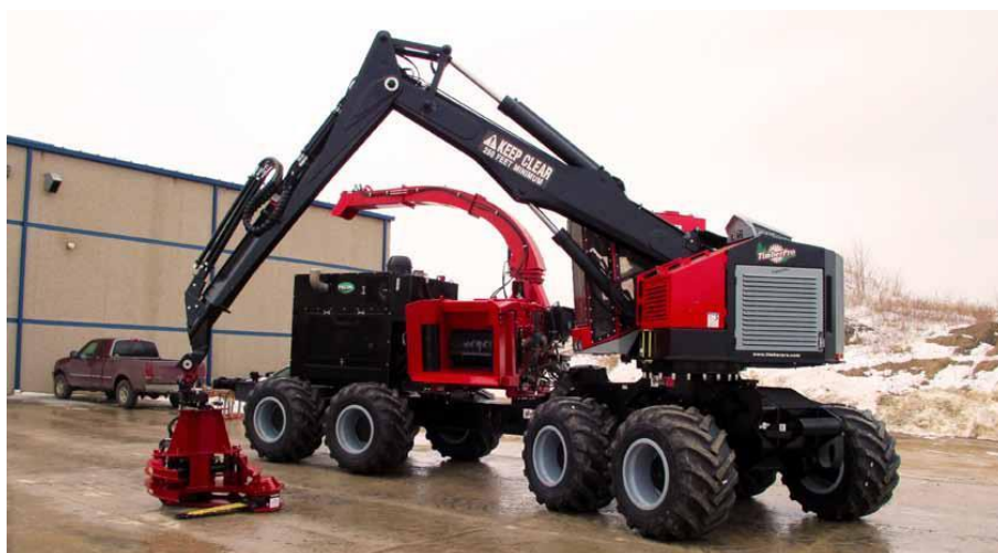
TimberPro 830B - Fecon RTC22p/500-8 döntőfejjel (Forrás: www.greenmediaonline.com )
