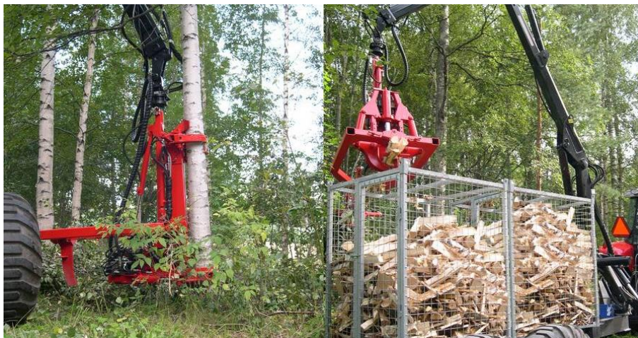
23. melléklet: Nokka Brennholzharvester döntő–gallyazó–hasító–daraboló gép (Forrás: www.nokka.fi )
