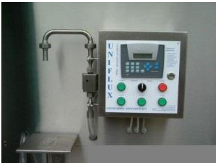
9. melléklet: Szivattyú nélküli adagoló egység (Forrás: internet)
