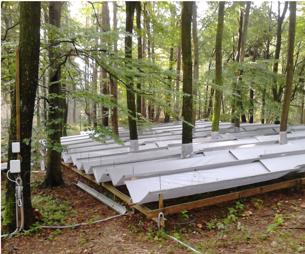
15. ábra. Moduláris takarórendszer a szárazság szimulálásához.
