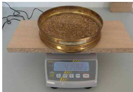
36. ábra. KERN PCB 3500-2 típusú digitális precíziós mérleg (mérés határ: 3500 g, felbontása: 0,01 g, pontossága: \pm 0,05\% )
