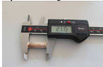
56. ábra. Pellet hossz mérés digitális tolómérővel (felbontása: 0,01mm; pontossága: \pm 0,02\% )
