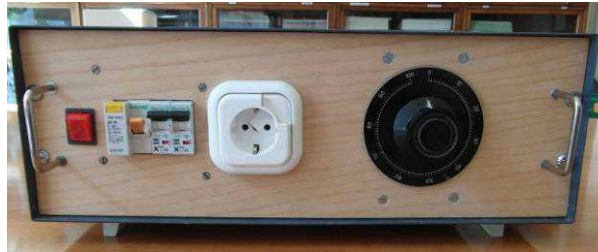
44. ábra. Hőmérsékleti értékek szabályozására alkalmas egyedi tervezésű és kivitelezésű tápszekrény
