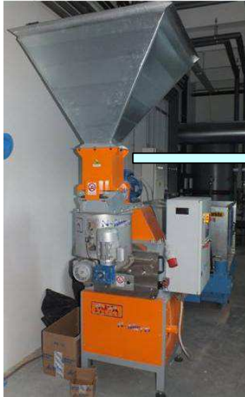
34. ábra. NOVA PELLET N-MICRO B típusú pelletáló gép (maximális kapacitása folyamatos alapanyag adagolás mellett: 200 kg/óra)
