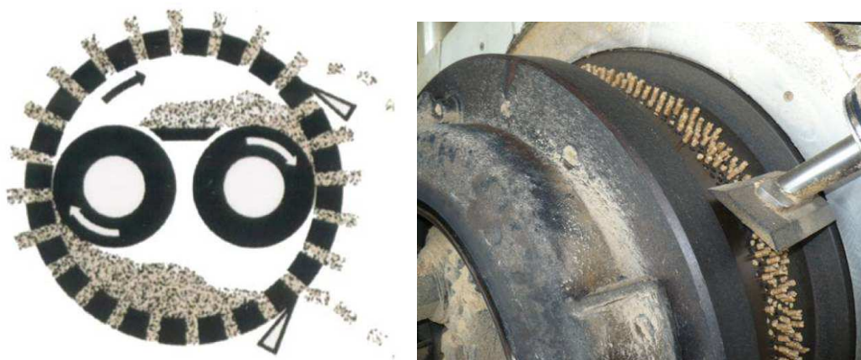
7. ábra. Pelletáló berendezés alapegysége: matrica és a görgők (Forrás: Bal oldali ábrarész: [BURJÁN, 2009]; a jobb oldali ábrarész: [NÉMETH et al., 2012])
