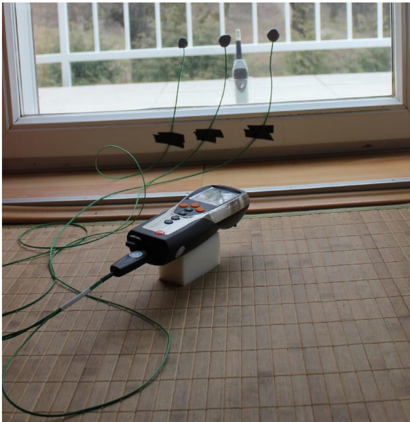
29. ábra. TESTO mérőeszközök elhelyezése a helyszíni mérés során
