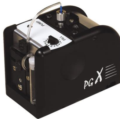
37. ábra. PGX goniométer adhézió és nedvesíthetőség mérésére [Forrás: web 8]
