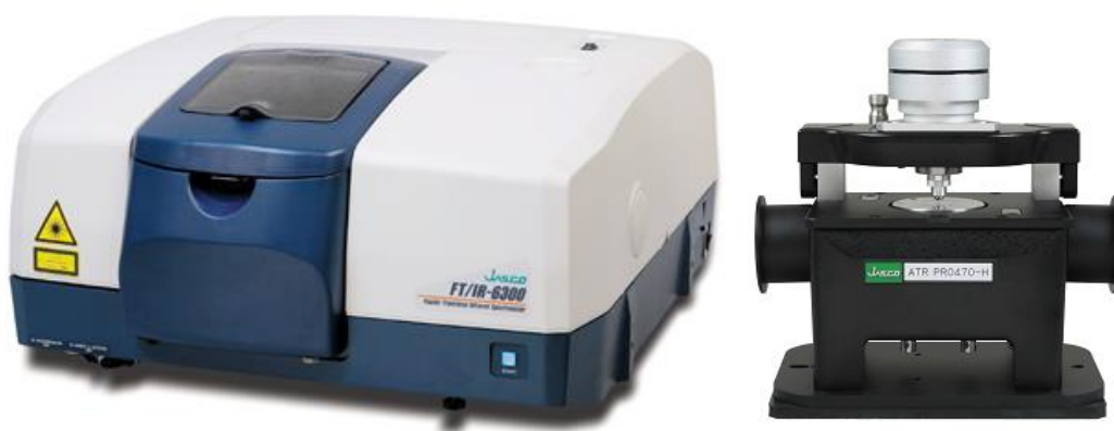
36. ábra. Spektrofotométer (bal oldal), ATR PRO450-S feltét (jobb oldal) [Forrás: web 7]
