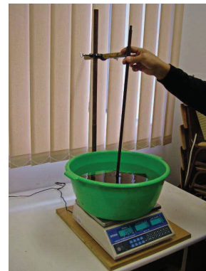
22.ábra A törzsmetszetek (korongok) térfogatának meghatározása
