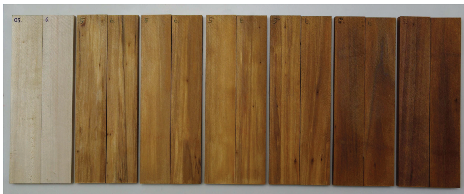
13.ábra Növényi olajban kezelt 'Pannonia' nyár különböző hőmérsékleteken illetve időtartamon (fotó: Bak)
