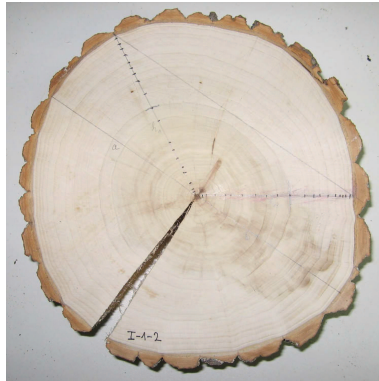
16.ábra Évgyűrűszélesség meghatározása
