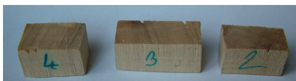
17.ábra SEM-os elemzéshez előkészített 'I-214' nyár minták
