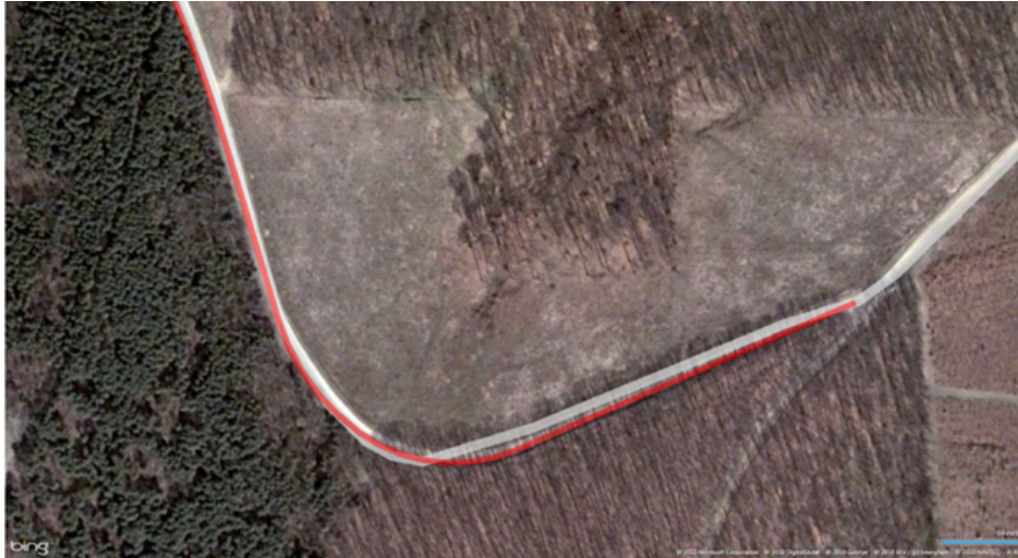
2.4. ábra. Rekonstruált úttengely (piros vonal), Bing Maps vektor réteg (fehér vonal).
