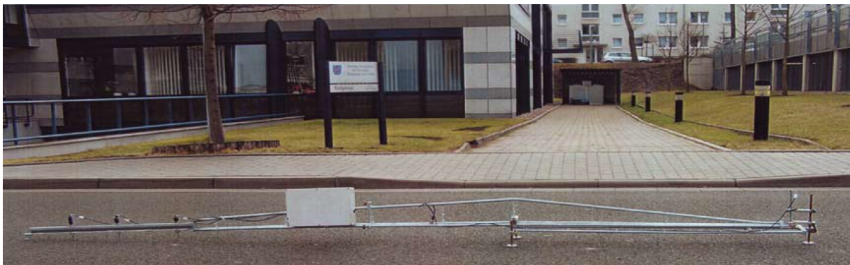
5.13. ábra. Automatizált Benkelman-tartó, Németország (Dähnert, 2005).
