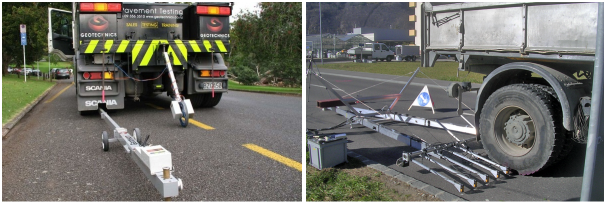
5.12. ábra. A Geobeam (Anderson, 2008) és az EHT Delta eszköz (Rabaiotti, 2008).
