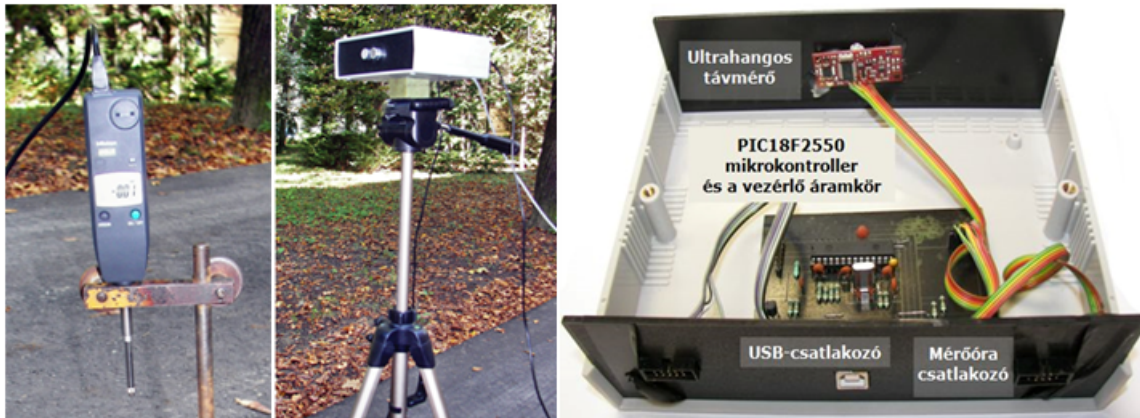
5.15. ábra. Digitális elmozdulásmérő óra és központi adatgyűjtő-vezérlő egység távmérővel.
