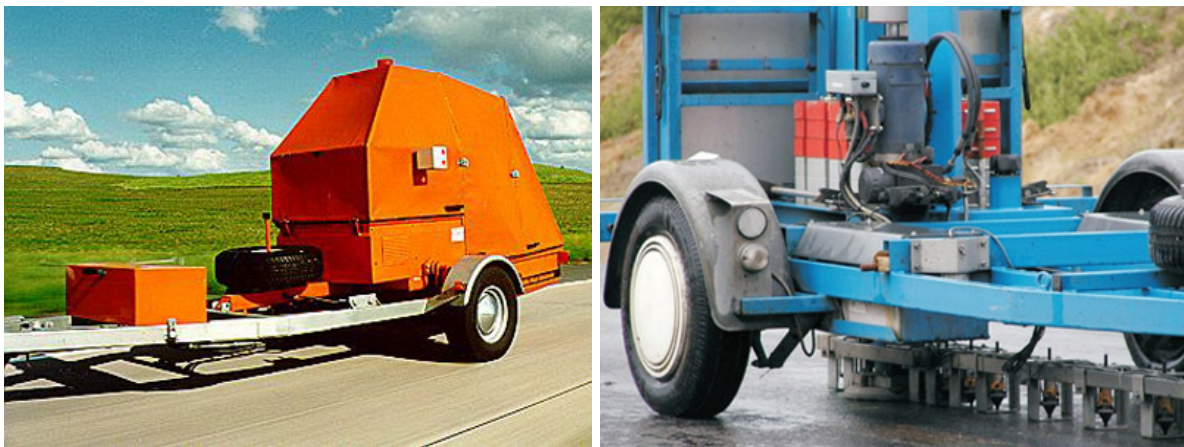
5.8. ábra. KUAB (a) és Dynatest típusú (b) FWD készülékek.
