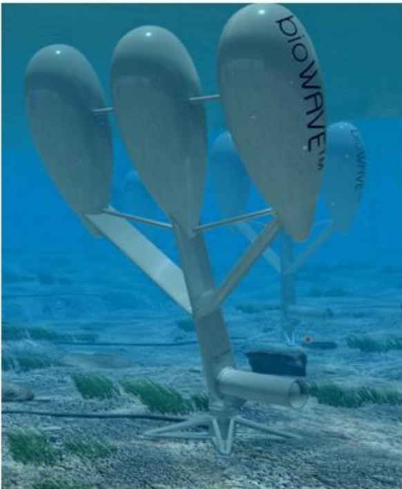
BioWave Óceániai Energia Rendszer, terv: Timothy Finnigan, BioPower Systems Pty Ltd./ Energia szekció
