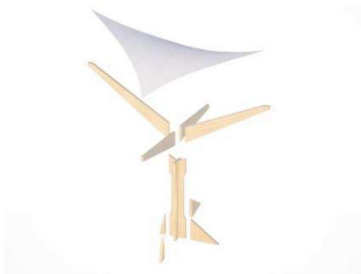
10.6.2 ábra: a norvég pavilon tartószerkezete
