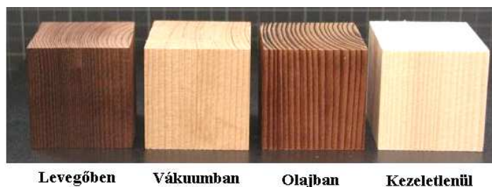
17. ábra Lucfenyő színének változása 200°C-os hőkezelések esetén NIEMZ (2004)
