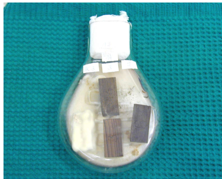
9. ábra Hőkezelt erdeifenyő próbatestek gombaállósági vizsgálata , kezeletlen (bal oldali) Vizsgálati gombafaj: Lepketapló ( Coriolus versicolor ) (NYME 2006a)
