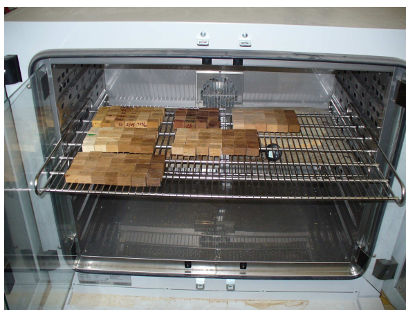
26. ábra A próbatestek kondicionálása Binder típusú klímasekrényben
