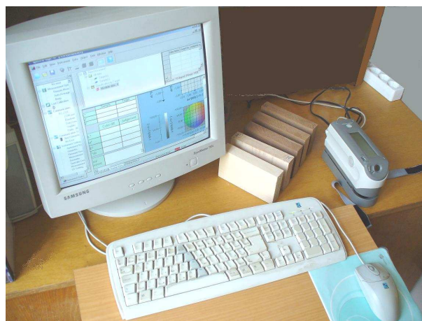
27. ábra CIE-Lab színinger tér (bal), Színmérés spektrofotométerrel (jobb)
