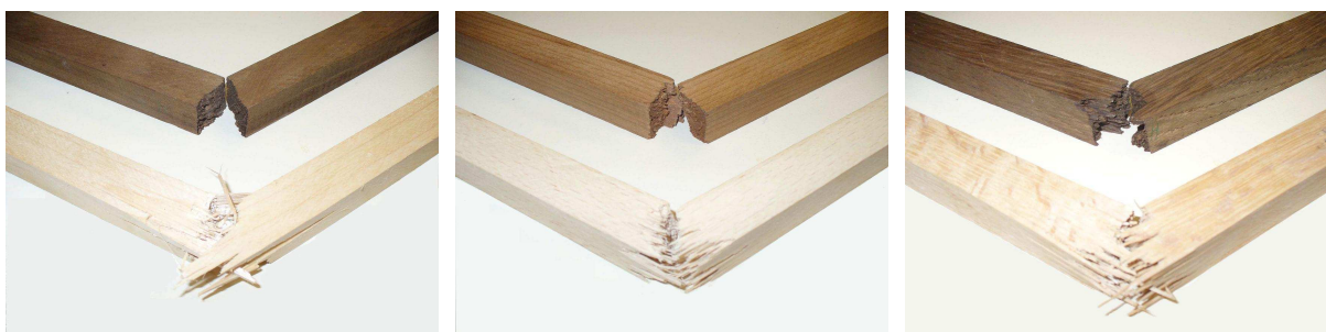
32. ábra A kezeletlen fa szálkás és a hőkezelt fa tompa törési képei (balról jobbra: nyár, bükk, cser)
