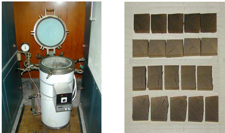
22. ábra Hőkezelő autokláv (bal), Repedések képződése a hőkezelt csertölgyben (jobb)
