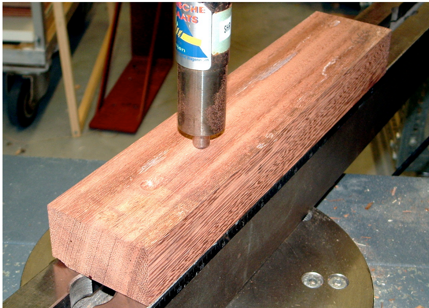
28. ábra Keménységmérés Janka-módszerrel: a próbatetek kialakítása, mérési pontok, és a mérés kivitelezése
