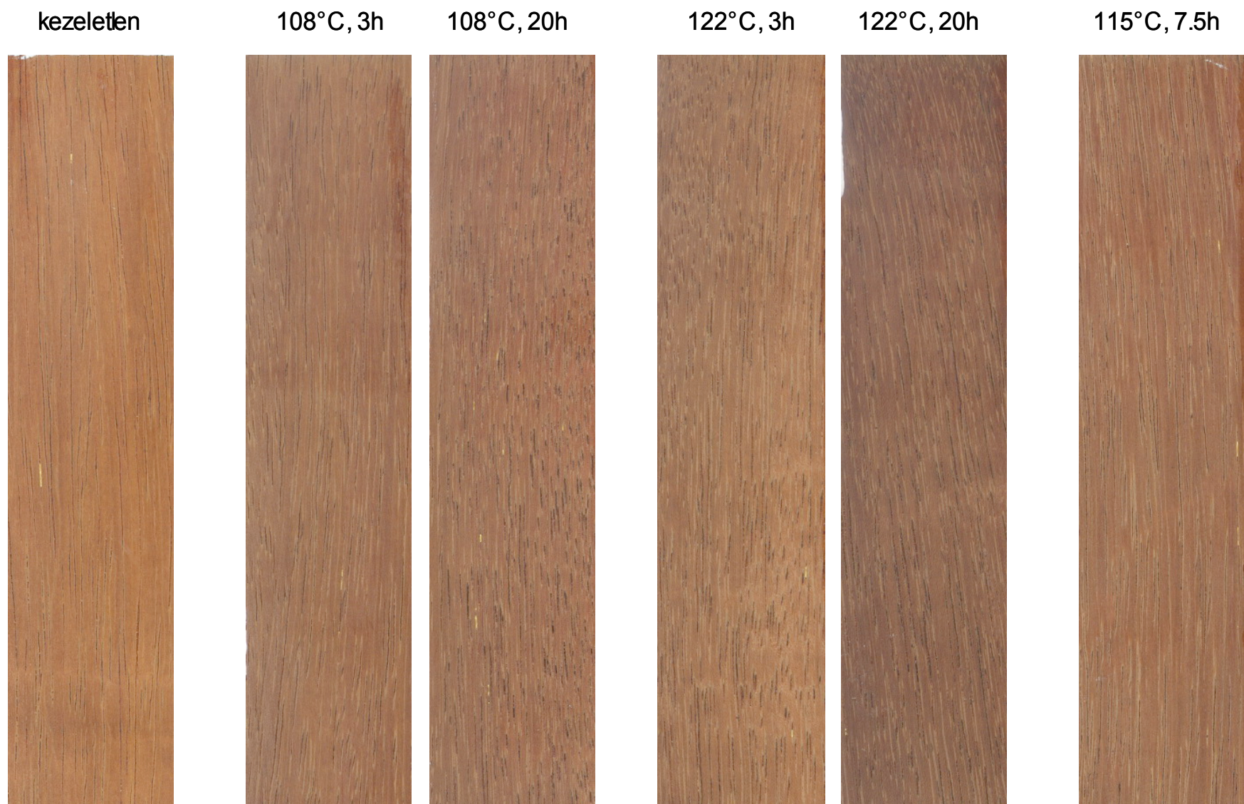
F4. ábra Kezeletlen és különböző paraméterekkel gőzölt merbau fafelületek
