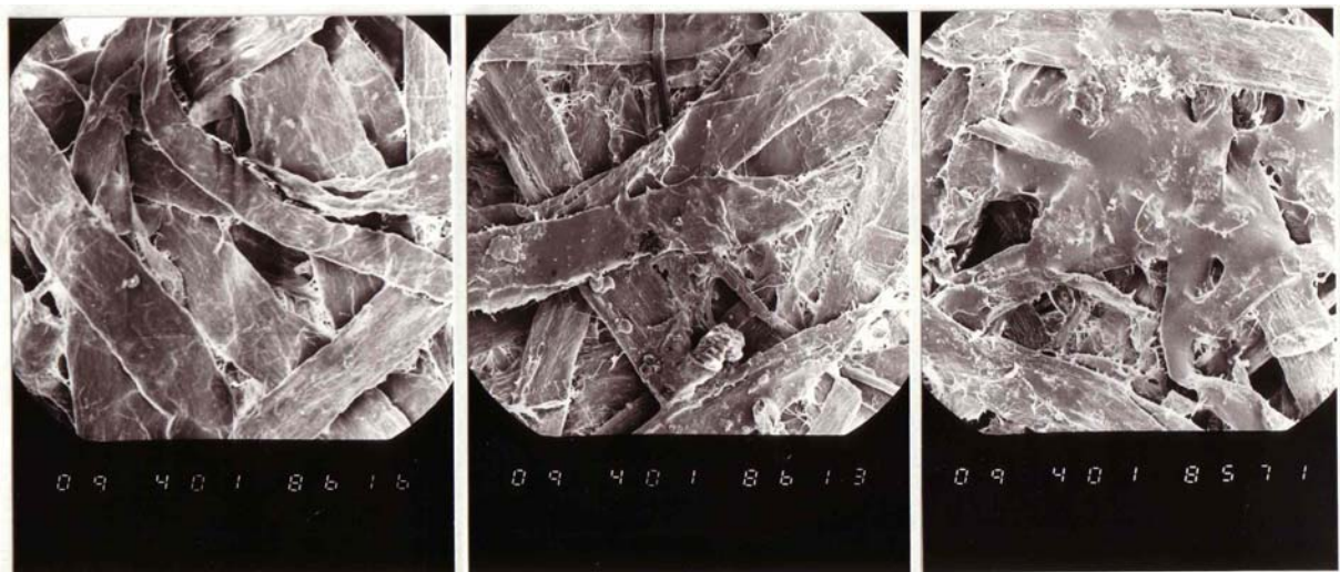
2. ábra A kezeletlen, az ojtott és a kalanderezett ojtott cellulóz elektronmikroszkópos felvételei 400 – szoros nagyításban
