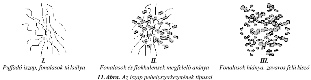
11. ábra. Az iszap pehelyszerkezetének típusai
