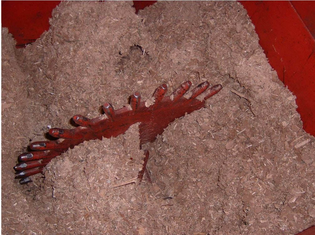
TÜZELŐANYAG A SILÓBAN A BOLYGATÓKERÉKKEL
