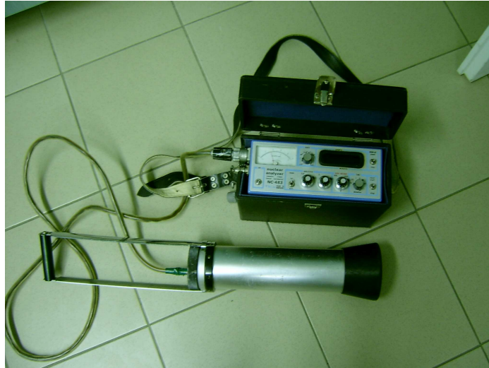
2.kép: NAI(Tl) detektoros gamma-dózisteljesítmény mérésére használt mérőeszköz
