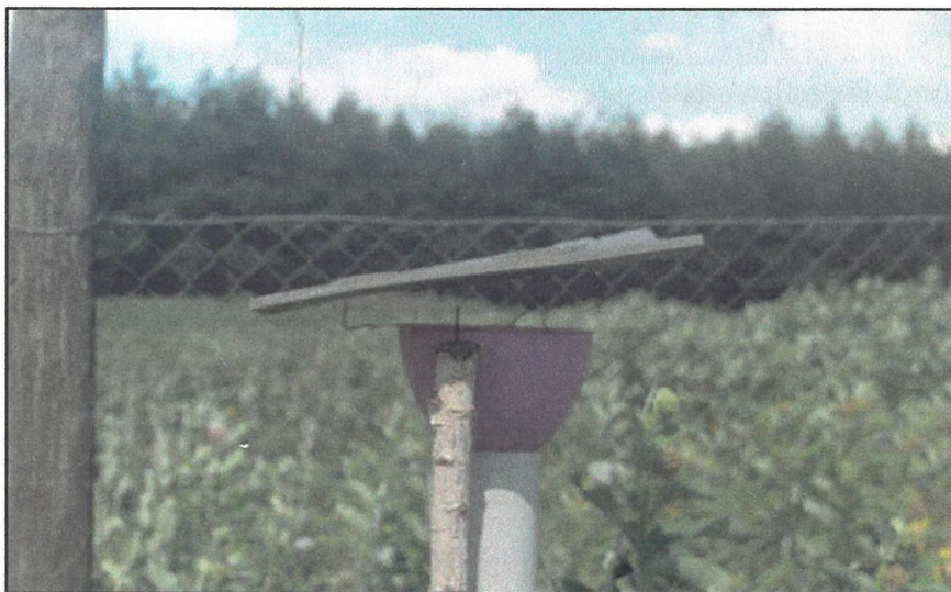
11. KÉP: A KORONÁN ÁTCSÖPÖGŐ CSAPADÉK ÉSZLELESEK KÖZTI PÁROLGÁSI VESZTESÉGÉNEK MÉRÉSÉRE SZOLGÁLÓ ESZKÖZ
