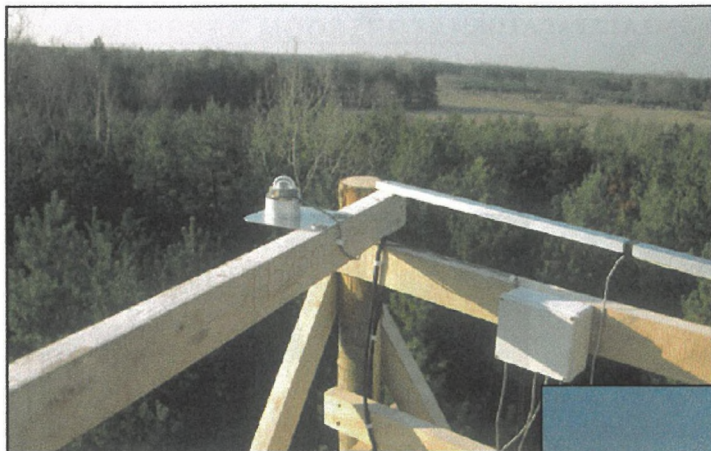
2. KÉP: KIPP & ZONEN PIRANOMÉTER A KÍSÉRLETI ÁLLOMÁNY FELETT (HÁTTÉR BEN A VADFÖLD)
